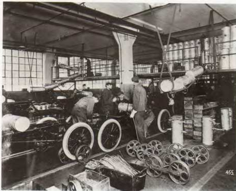
Установка бензобаков автомобиля Модель Т, 1914
