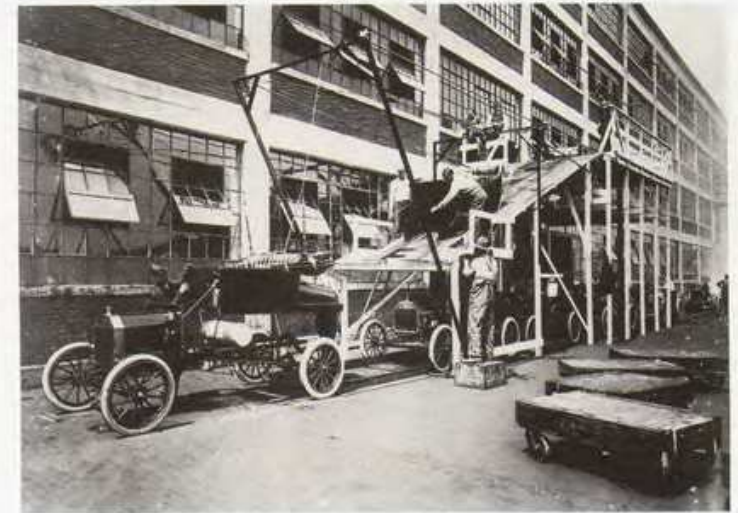
Установка кузовов автомобиля Модель Т, 1914
