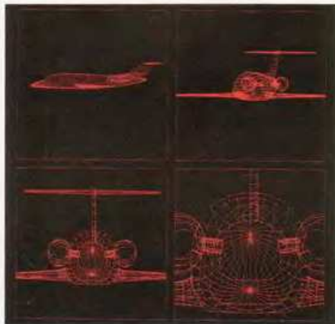
Графическая система 5080 компании IBM, способная вращать, монтировать и увеличивать плоские и объемные изображения моделей, 1990-е
